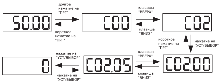
Рисунок 5.5-3. Основные операции на панели управления
